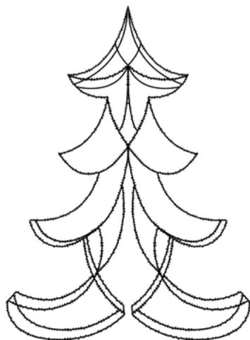
Struttura in ferro zincato, cablata con Catena lineare XML 96 MaxiLED BIANCO ø7mm, Serie LED 24V Professional 3pins.
